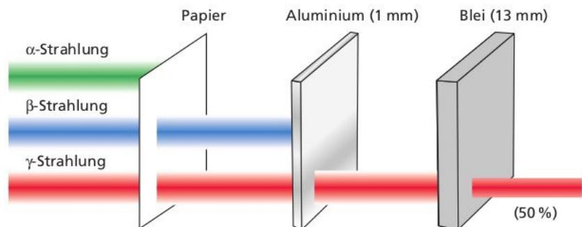
Das Durchdringungsvermögen von  $\alpha$ -Strahlung ist am kleinsten, das von  $\gamma$ -Strahlung am größten.
