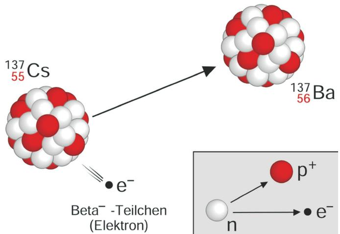
Cäsium-137 wandelt sich unter Aussenden eines Elektrons in Barium-137 um. Da die Elektronen je eine negative Elementarladung tragen, werden die Strahlen auch als Beta<sup>-</sup>-Strahlen bezeichnet.
