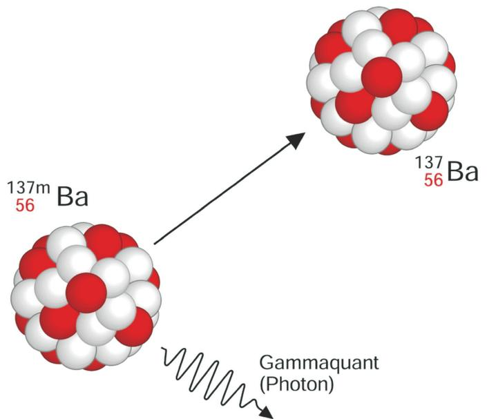
Ein energiereicher, angeregter (metastabiler) Bariumkern gibt ein Gammaquant ab und geht dadurch in einen niedrigeren und gleichzeitig stabileren Energiezustand über.
